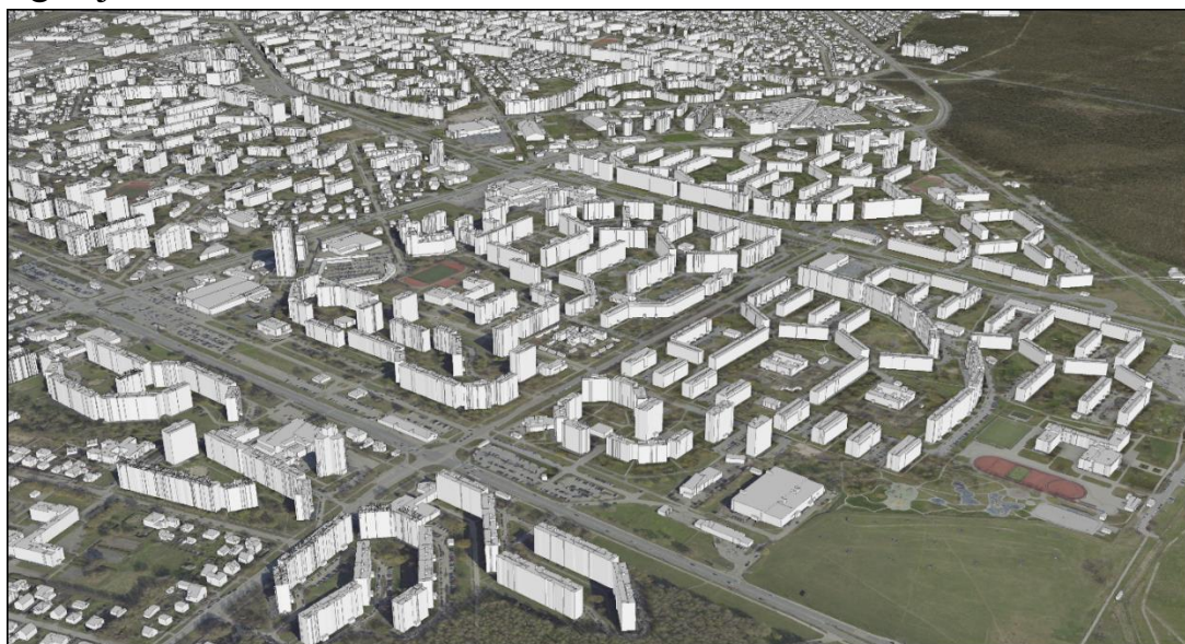
Vektorizētais LOD 2 ēku modelis Rīgas teritorijai, sagatavots no 2021. gadā iegūtajiem aerolāzerskenēšanas datiem
