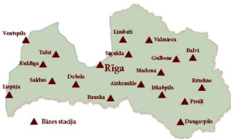
Globālās pozicionēšanas sistēmas Latvijas pozicionēšanas sistēmas bāzes staciju tīkla shēma
